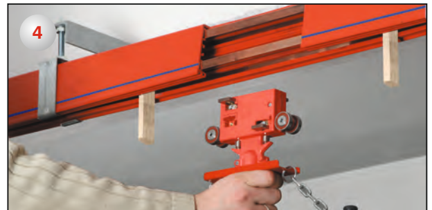
4 Для монтажа токосъемника следуйте описанным действиям в обратном порядке.
